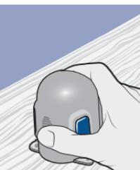
8. Utisnite serter na postolje tako da podnožje sertera ravnomjerno dотиче podlogu i da se začuje klik.
